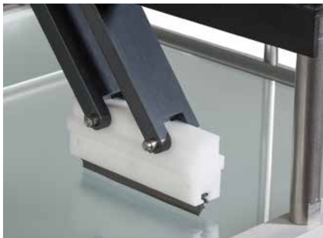
Стойкость к истиранию стекла с покрытиями (по изменению мутности) % мутности (ASTM D 1003)
